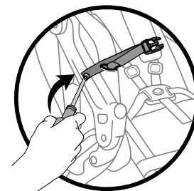
Al siguiente, inserte el tornillo fijo con la hebilla (hembra) completamente en la tuerca de anclaje del lado izquierdo del adaptador accesorio del cochecito y ajústelo firmemente.
