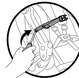
Ensuite, vissez la vis captive avec la boucle (femelle) à fond dans l'écrou à rivet sur le côté gauche de l'adaptateur d'accessoire de la poussette, et serrez fort.
