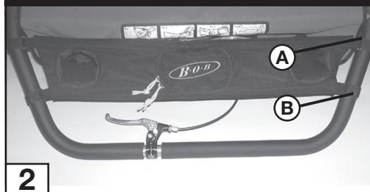
**2.** Continuer d'enrouler la bande crochet et boucle autour du guidon et l'insérer dans le passant en plastique noir (Fig. 3).
