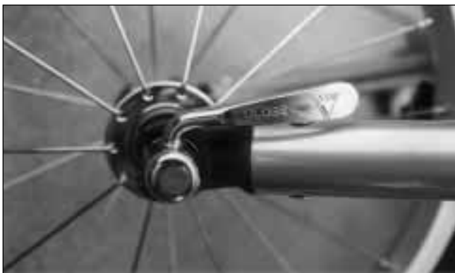
Fig. 9 - Quick release in the closed position and parallel to frame tube. Position fermée du serrage rapide et parallèle au tube du cadre. Schnellspanner in geschlossener Position und parallel zum Rahmenrohr.
