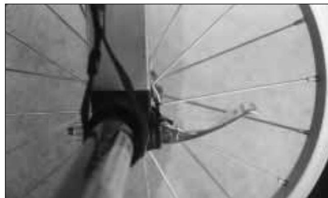
Fig. 12 - Quick release perpendicular to the dropout. Serrage rapide perpendiculaire à la patte de roue. Schnellspanner im rechtem Winkel zur Radachse.
