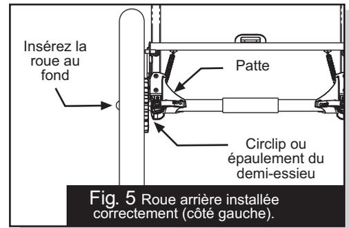
Fig. 5 Roue arrière installée correctement (côté gauche).
