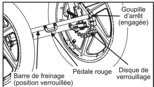
Fig. 16 Frein de stationnement – position verrouillée.
