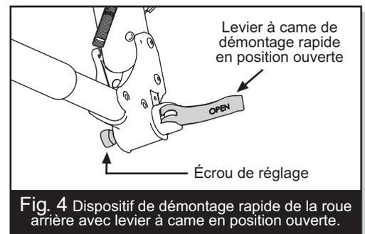
**Fig. 4** Dispositif de démontage rapide de la roue arrière avec levier à came en position ouverte.
