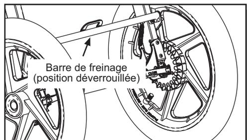
Fig. 17 Frein de stationnement – position déverrouillée.
