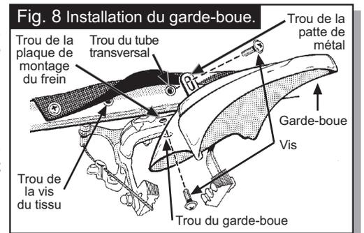
Fig. 8 Installation du garde-boue.
