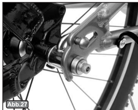
Abb.27 Richtig ausgerichtete Ausfallenden der Deichsel und richtig angebrachte Spezialaufnahmen
